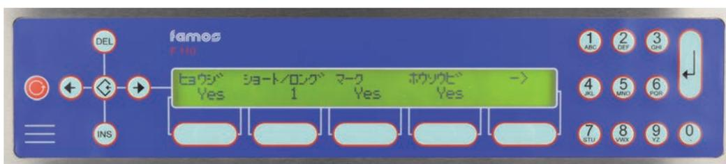
滅菌バッグに印字するマーク、滅菌日、文字の大きさ、印字の有無を設定
