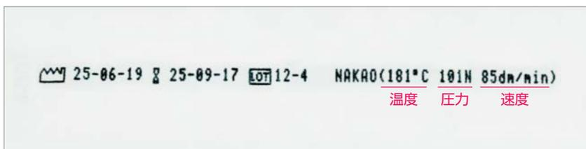
滅菌バッグに直接印字できるので装置のコンディションを簡単に記録できます。
